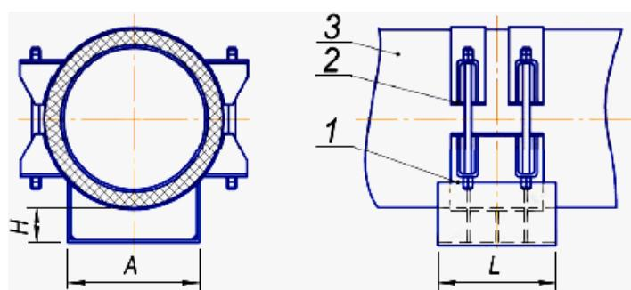
1 - корпус; 2 - бугель; 3 - стальная труба в ППМ изоляции;  $L$  - длина бугельной скользящей опоры;  $H$  - высота бугельной скользящей опоры;  $A$  - ширина бугельной скользящей опоры
