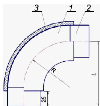
1 - стальной отвод; 2 - стальной патрубок; 3 - ППМ изоляция;  $R$  - радиус отвода;  $L$  - длина плеча отвода
