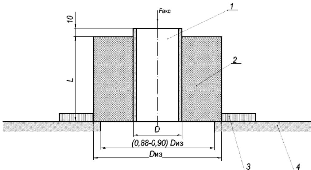
1 - стальная труба; 2 - ППМ изоляция; 3 - направляющая; 4 - упор;  $L$  - длина образца;  $D$  - диаметр стальной трубы;  $Di$  - диаметр изоляции;  $F_{\text{акс}}$  - осевая нагрузка
