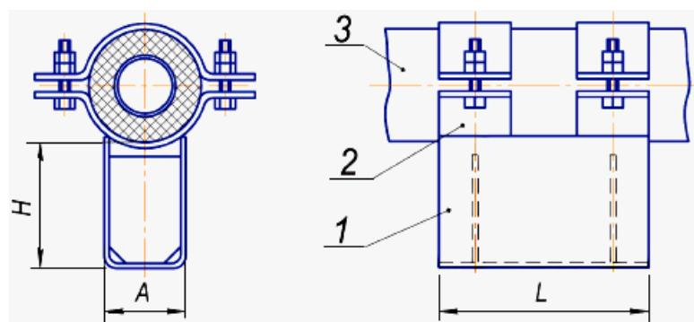
1 - корпус; 2 - хомут; 3 - стальная труба в ППМ изоляции;  $L$  - длина хомутовой скользящей опоры;  $H$  - высота хомутовой скользящей опоры;  $A$  - ширина хомутовой скользящей опоры
