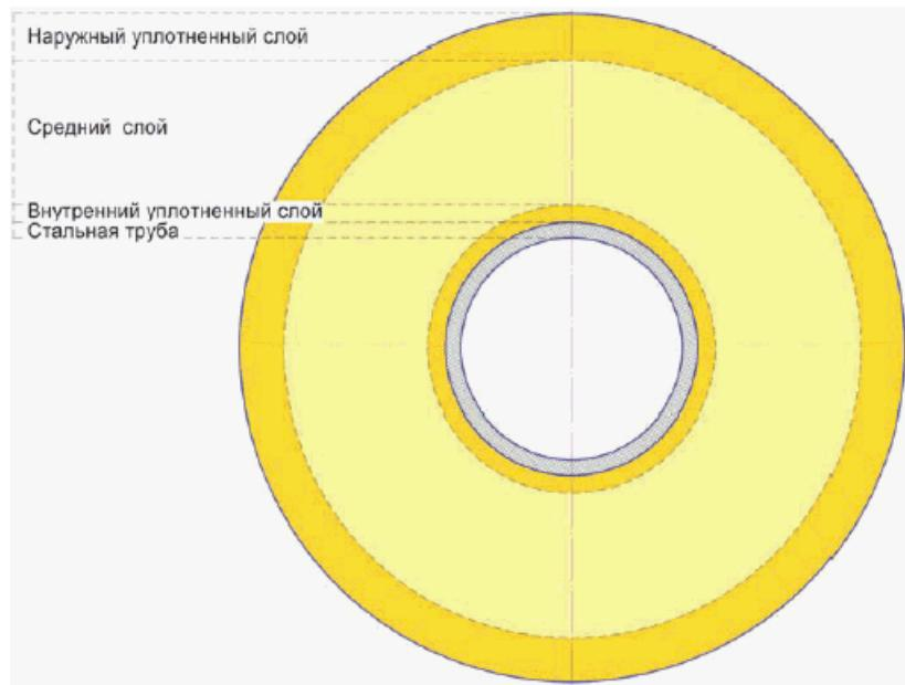
Рисунок 1 - Структура ППМ изоляции на трубопроводе
